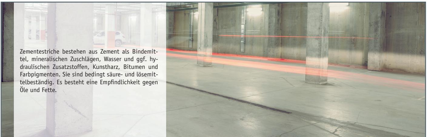
Zementestriche bestehen aus Zement als Bindemittel, mineralischen Zuschlägen, Wasser und ggf. hydraulischen Zusatzstoffen, Kunstharz, Bitumen und Farbpigmenten. Sie sind bedingt säure- und lösemittelbeständig. Es besteht eine Empfindlichkeit gegen Öle und Fette.
